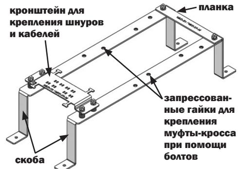
**3.2.2** Закрепить на «Универсальном кронштейне» муфту-кросс при помощи 4-х крепежных болтов, вкрутив их в запрессованные гайки.
