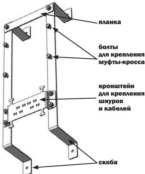
**3.1.1** Перед закреплением кронштейна на стене или опоре необходимо смонтировать кронштейн, соединив скобы при помощи планки и кронштейна, используя гайки с шайбами.
