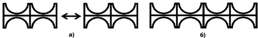
Рисунок 9.14 – Горизонтальное соединение кластеров ССД а – направление соединения; б – блок из двух кластеров, соединённых по горизонтали
